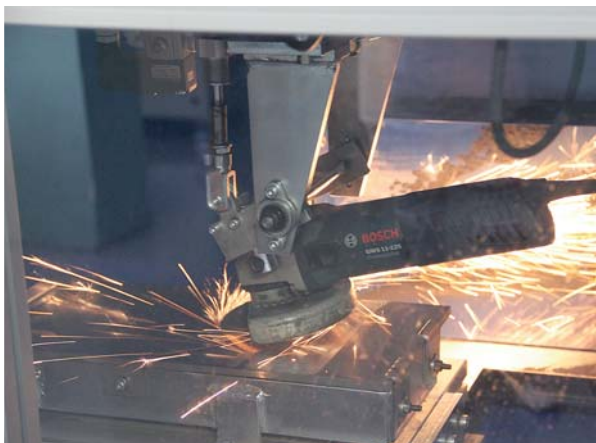
Автоматический стенд для испытаний лепестковых кругов на износостойкость. В качестве привода круга используется УШМ, сам стенд обеспечивает смещение заготовки относительно круга по заданной программе
