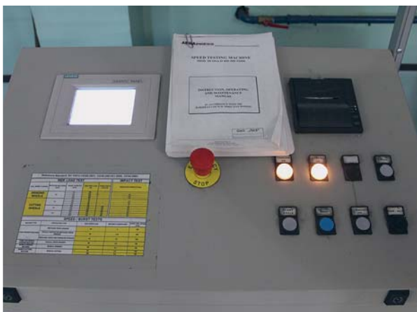
Стенд для проведения испытаний на механическую прочность (слева) и его пульт управления. Позволяет тестировать круги не только на скорость разрыва, но также и на устойчивость к боковой нагрузке
